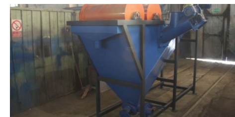
Ванна флотации «ПроСорт ВФ-1» для мойки ПЭТ
