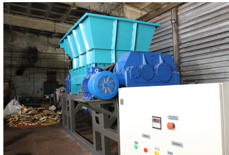
Двухвальный шредер мощностью до 270 кВт.
