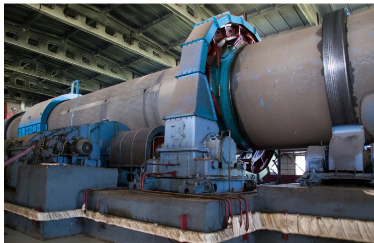
Биобарабаны Ø4x60 м KM 102Б/ Ø4x36 м KM 101
