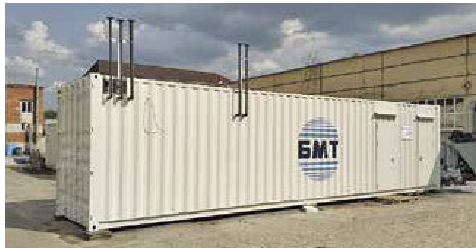
Универсальная станция очистки, которая включает обратноосмотические установки глубокой очистки и обессоливания фильтрата полигона ТКО.
