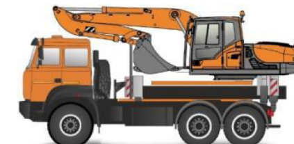
кскаваторы на автошасси
