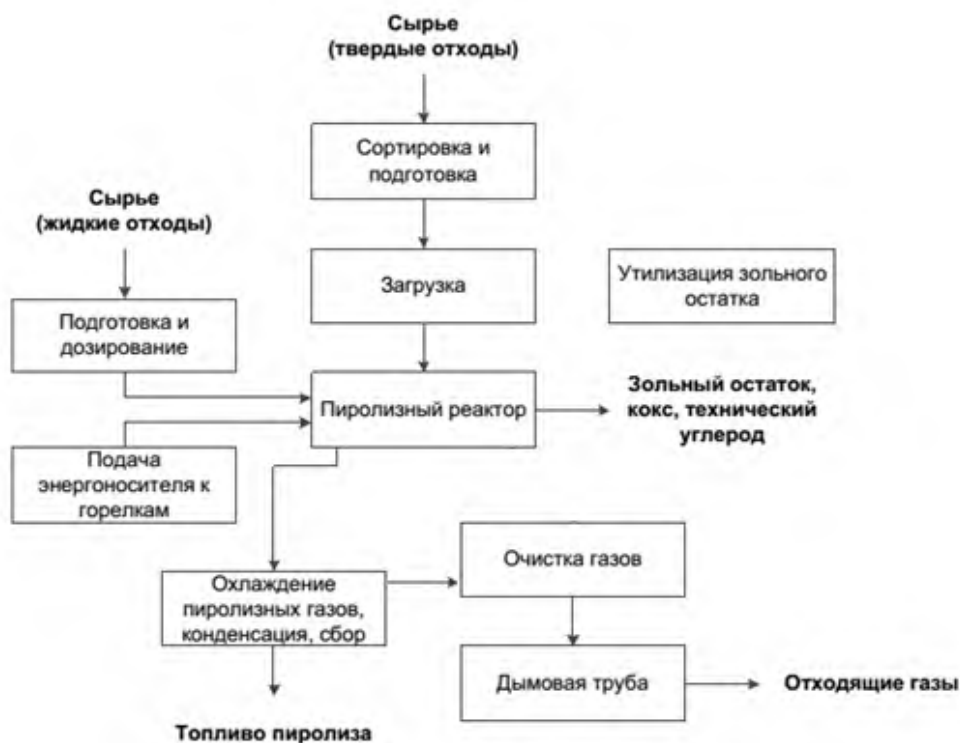
Рисунок 2.16 — Общая схема пиролиза отходов
